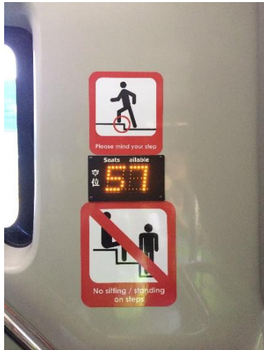
圖 11 往頂層樓梯處顯示空位數量
