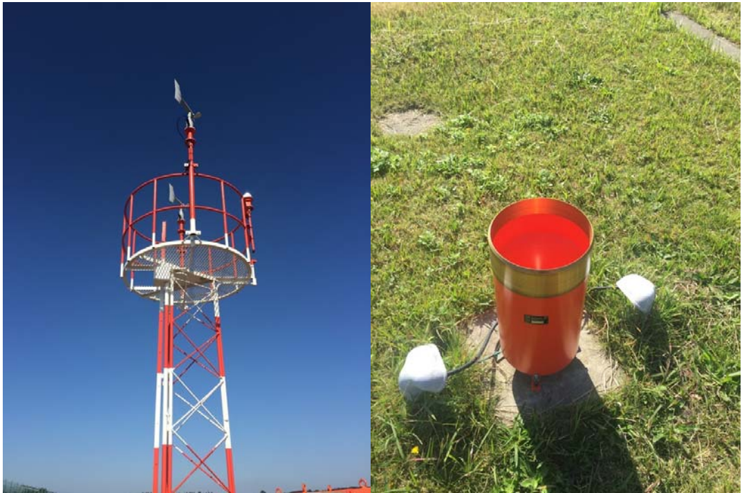
圖二十一、調布機場-風向風速計
