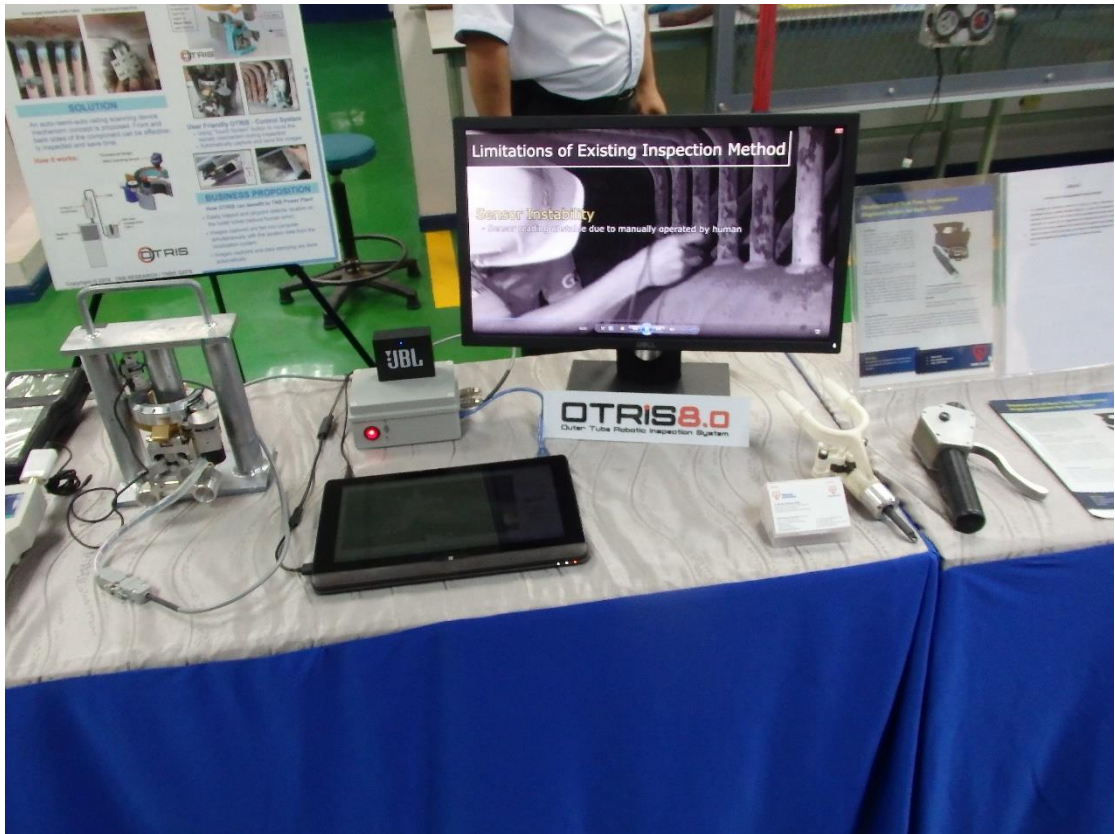
圖 18 鍋爐爐管厚度測試設備
