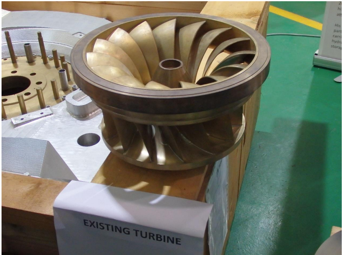
圖 13 TNB 公司所使用之現有水力渦輪
