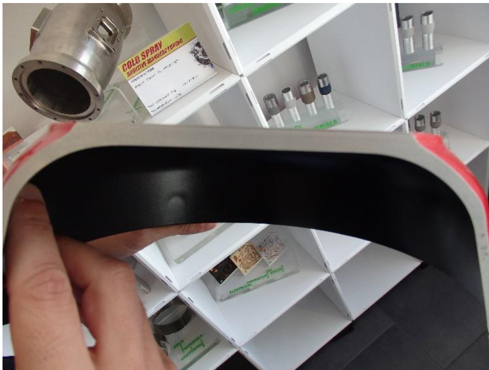
圖 30 以冷噴方式製造之鍋子
