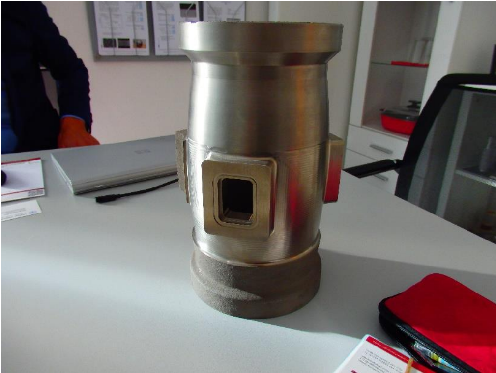
圖 31 冷噴後仍需精加工的工作
