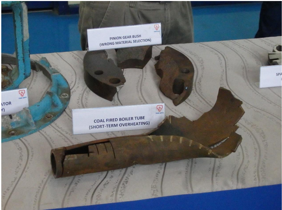
圖 19 鍋爐爐管破損案例
