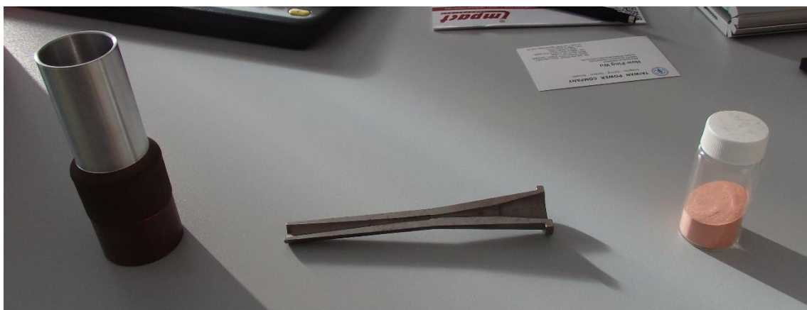
圖 28 冷噴於不鏽鋼表面、噴槍 nozzle-diffuser 及噴塗粉末
