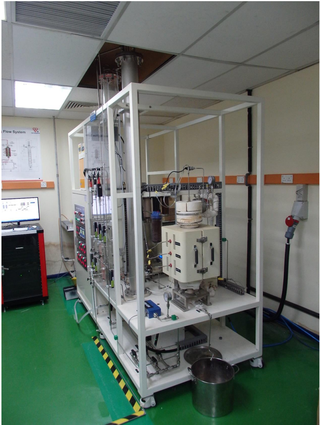
圖 20 鍋爐爐管測試平台
