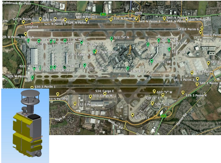
圖 7 利用微型感測器來監測英國希斯洛機場的空氣品質
