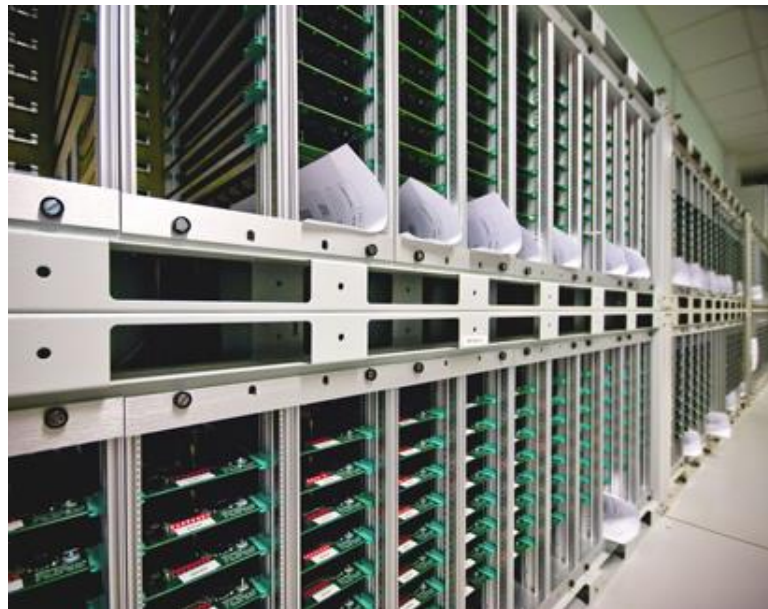
圖 2 Alphasense 公司氣體感測器自動化測試和驗證系統
