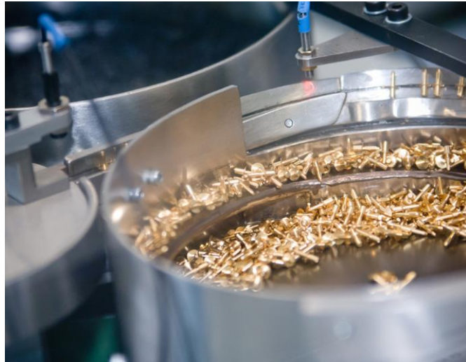
圖 1 Alphasense 公司氣體感測器針腳自動組裝模組
