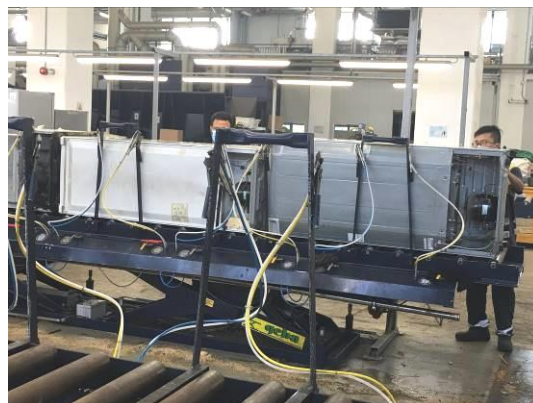
圖十一 冷媒抽取機台分別以黃色(可燃性 HC)及藍色(不可燃 CFCs)管線收集
