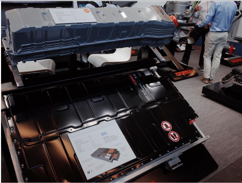
TORQEEDO 與 BMW 合作推出的船舶鋰電池組 (圖上為 i8 用款式約 10kWh、圖下 i3 用款式約 30kWh)
