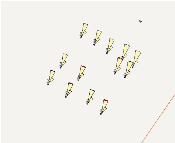
該風場佈置經重新調整如下圖示，各風機紅色面積為該風向之尾流發電損失已大幅簡小，原因在於各風機主風向與垂直風向之間距已增大，間距增大，尾流影響亦將減少，因此尾流所致之發電損失亦減少。
