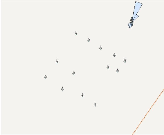
該風場經電腦軟體 WASP 模擬後如下圖，各風機之扇形面積為該風向之發電量，紅色面積為該風向之尾流發電損失，造成該尾流發電損失之主要原因為風向上風之風機尾流影響，一般而言，距風向上風風機具離愈近，尾流影響愈大，該尾流影響的發電損失約 3~5%，因此以該風場佈置為例作各風機間距重新調整。
