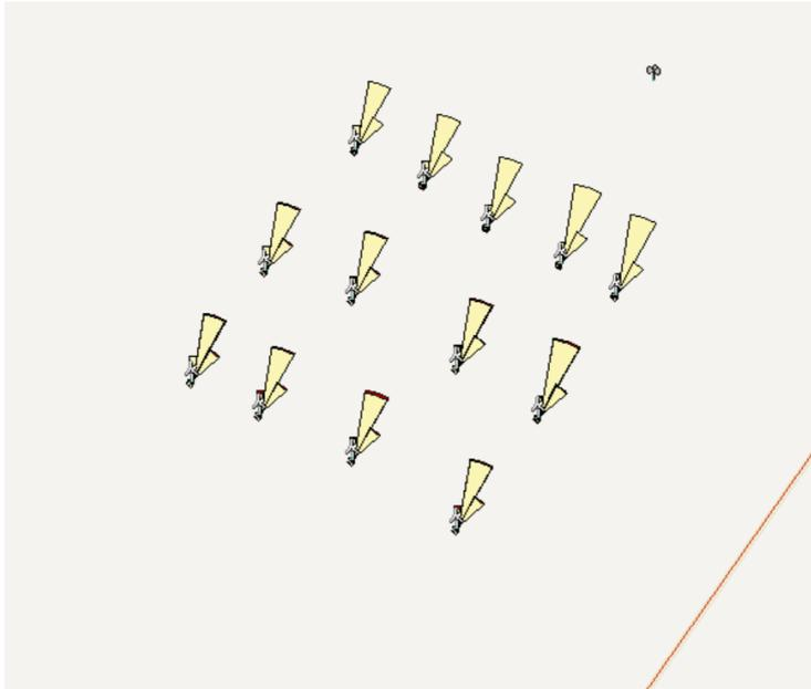
綜合以上，上述範例為簡易之電腦風場模擬及佈置，所須考量的事項甚多，風力發電風場的量測及評估是決定設置風場前必須經過相當的數據及統計的資料收集，以及計算之預測來做評估，包況長時間之風速資料統計，風能密度的蘊藏，環境評估，風能方向頻率，土地取得，交通運輸，景觀評估等，各項資訊及數據都需要在設置風場前，必須作周詳的評估，另性能曲線 Power Curve 為風力發電機的一個重要性能指標，它代表風力電能輸出及風速的關係，如何選定一個適合的風力發電機來裝置於該風力場址以充分利用該風場的能源，此外推力係數 Thrust Coefficient 亦為風機重要數據曲線，該數據可提供電腦模擬計算尾流損失之重要參數數據。
