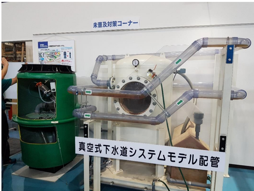
圖 43 真空下水道系統試驗管道
