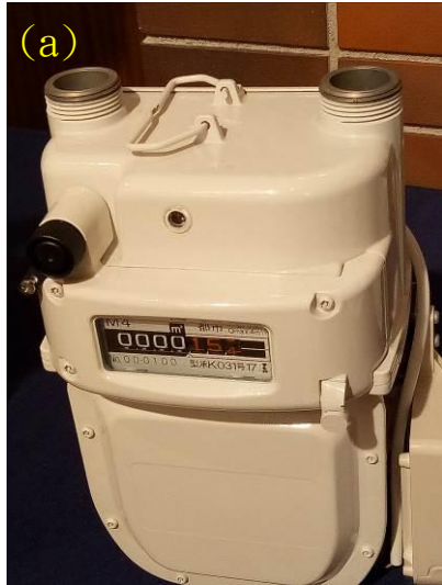
圖 11 (a) 智能皮膜錶；(b)智能超音波錶
