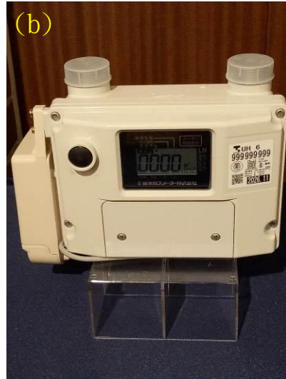
圖 11 (a) 智能皮膜錶；(b)智能超音波錶
