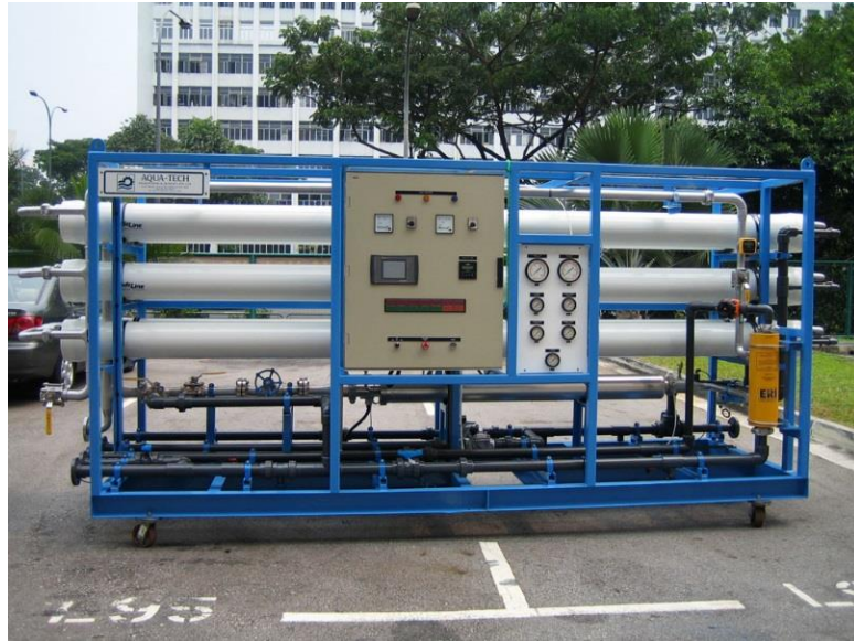
圖 3.7.5 日本 HITACHI 集裝箱式 SWRO 系統
