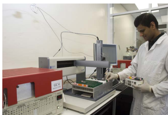
氣體自動檢驗甲烷濃度設備，每年 2 次校正
