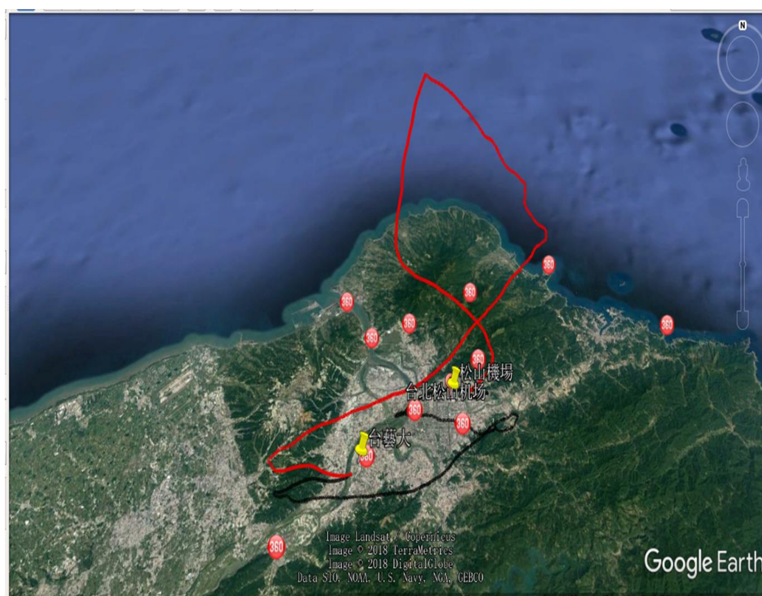
圖 1：探空儀在高空破裂後軌跡
