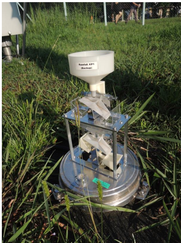
照片 9：地面觀測設雙傾斗雨量計
