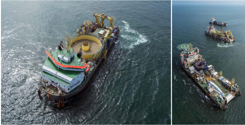
圖 10 Boskalis 鋪纜船施工
