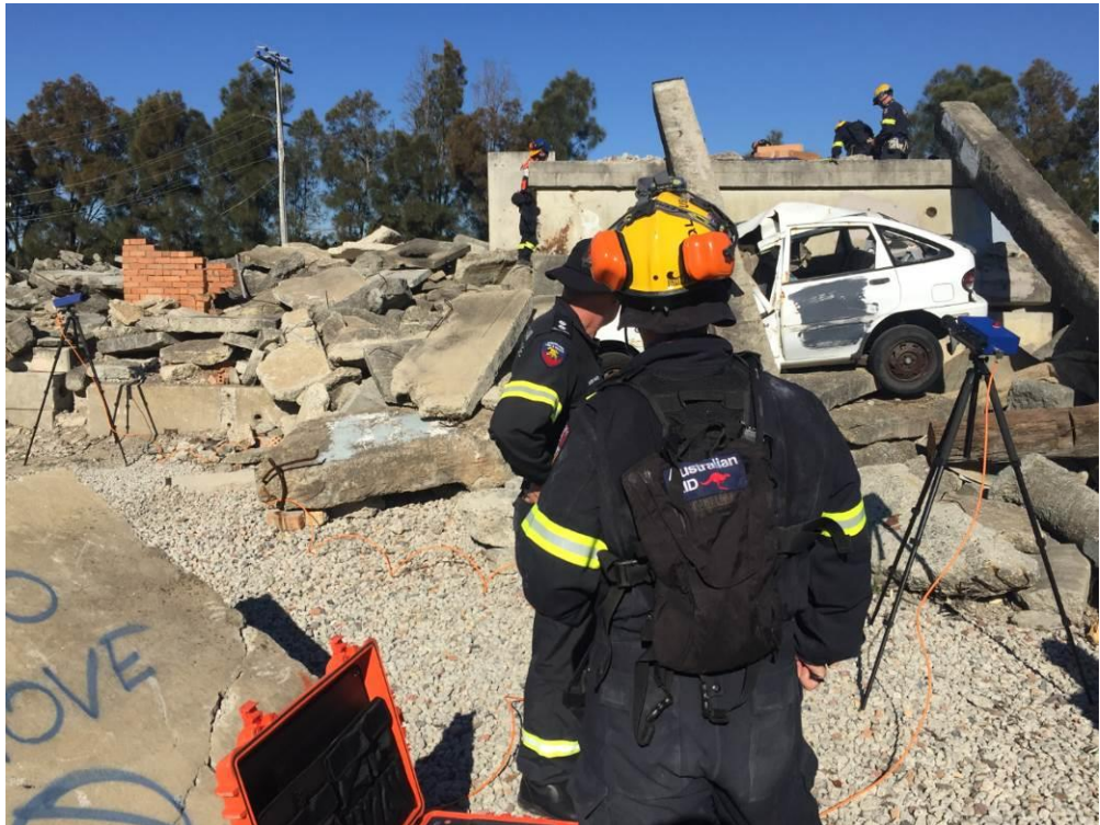
圖 35：利用雙點監測建築物位移
