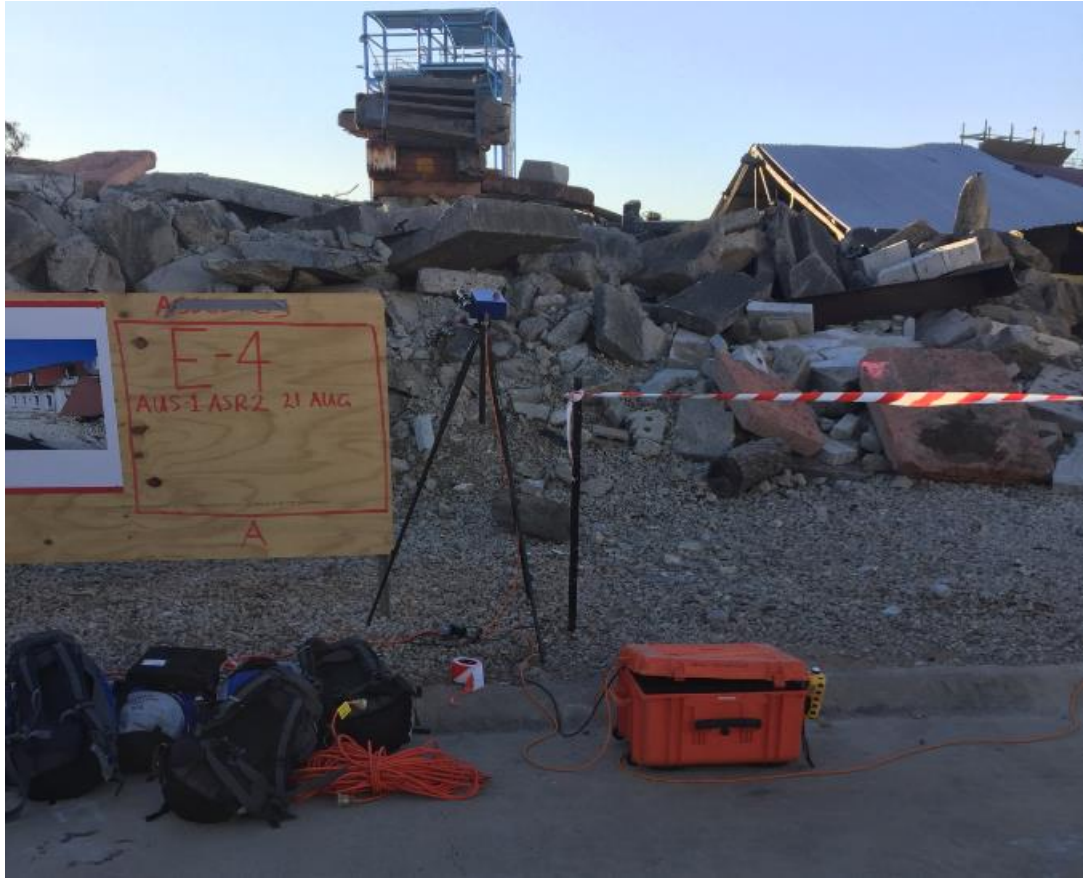
圖 15：利用紅外線監測儀監測建築物
