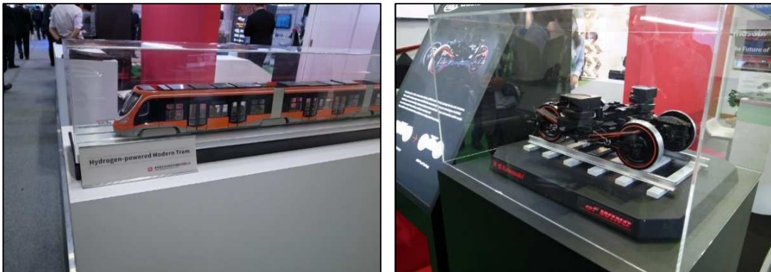
圖 2.26 Kawasaki™ 無接觸網電車(左)及新一代轉向架(右)
