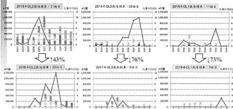
六輕所有燃燒塔廢氣量(開車時段+前後2日) vs 臭氣事件日站日數(日最大小時>120ppb, 全國77站)
