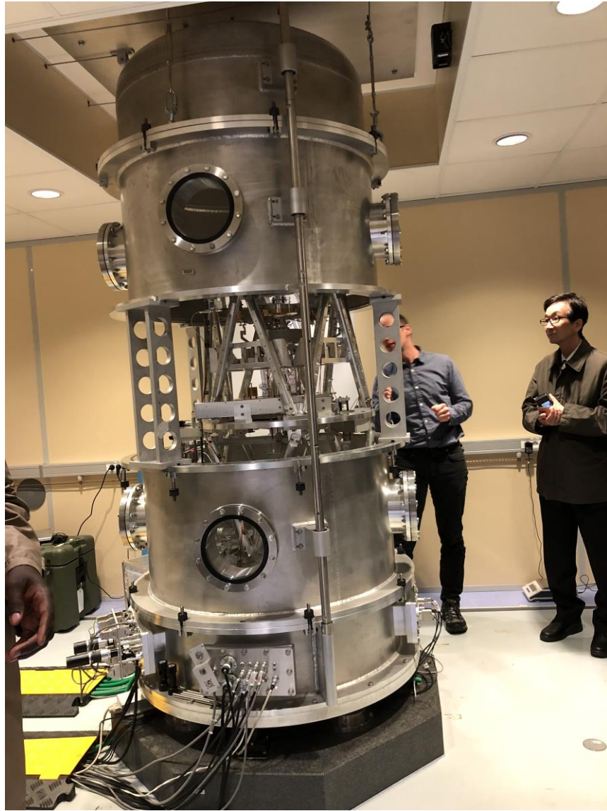
照片 3 BIPM 實驗室基布爾天平(Kibble Balance)系統全貌
