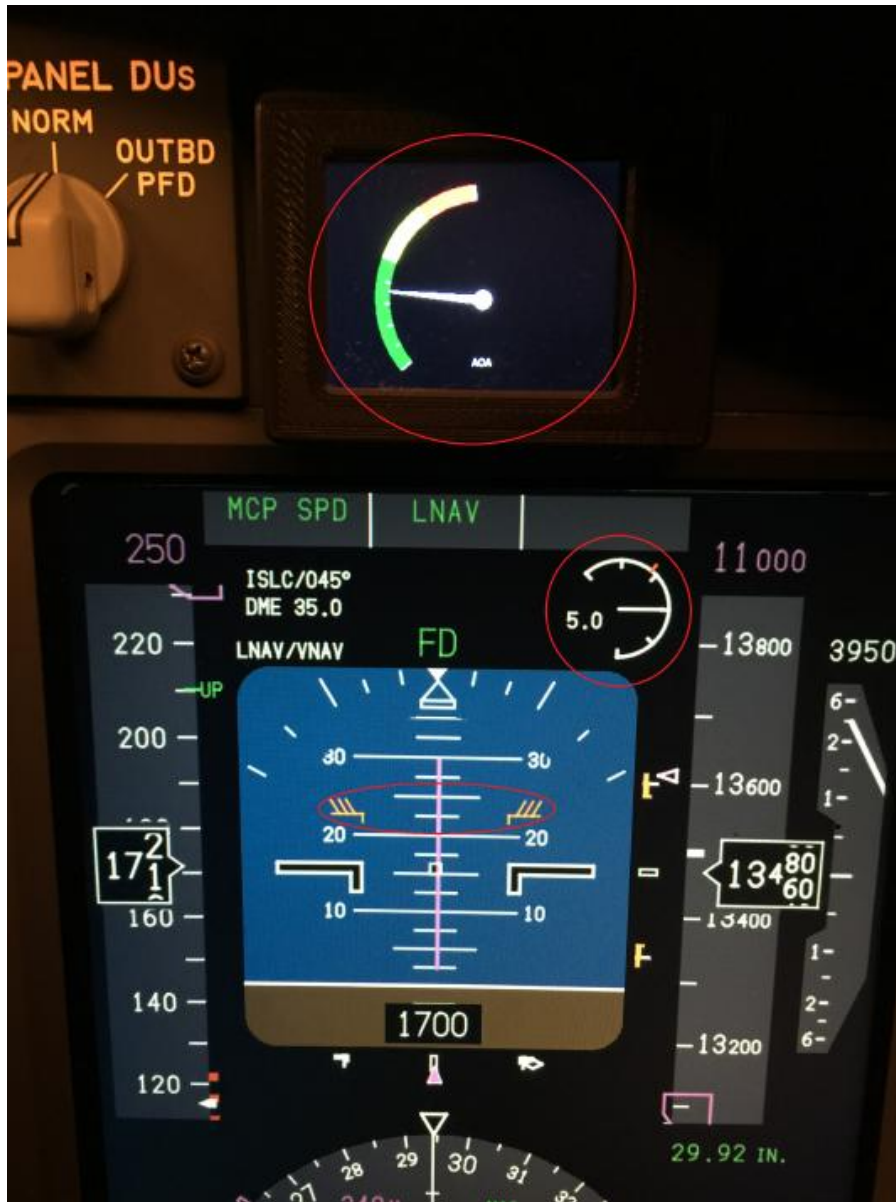
圖 8 波音 737-800 模擬器上 PFD 裝置攻角指示器位置示意
