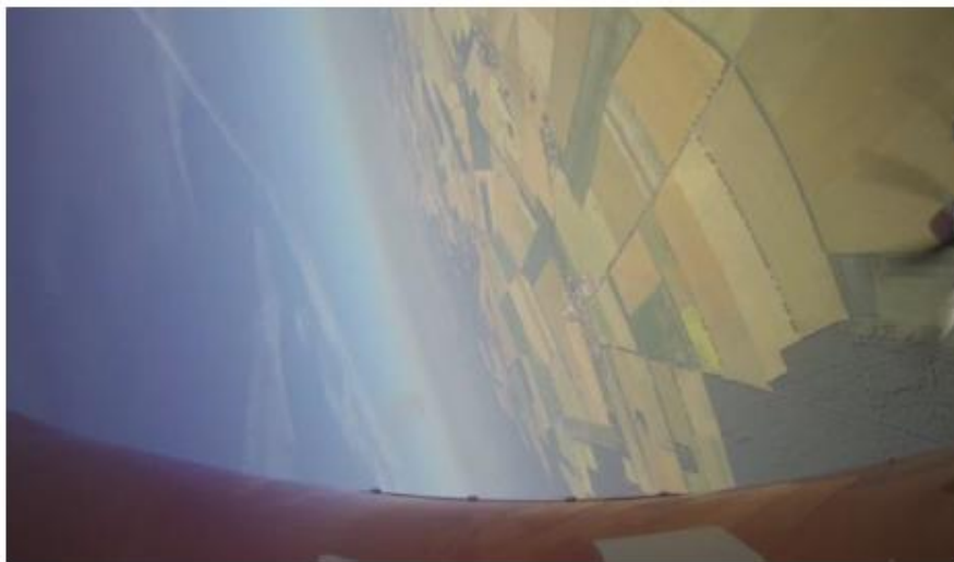
圖 11 DR 400 型機遭遇前方 900 公尺 AN-2 型機產生的渦流後產生的滾轉角視野
