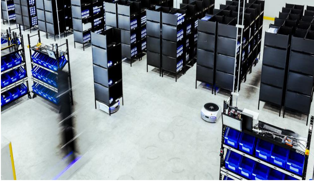
圖 5.1 機器人載貨在倉儲區流動
