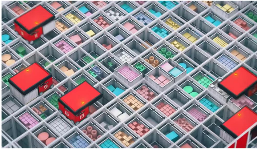
圖 2.3 機器人在軌道上來回移動取貨
