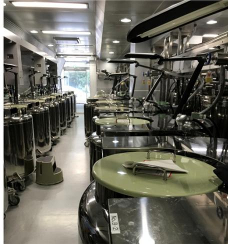
保存日本特有動物之細胞組織的液態氮筒，以中央控制系統偵測狀態及液態氮補充。
