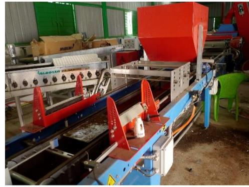
圖 46、在播種時有自動充填介質機及自動播種機一體而成，播種完成後即運送到溫網室進行育苗及嫁接。
