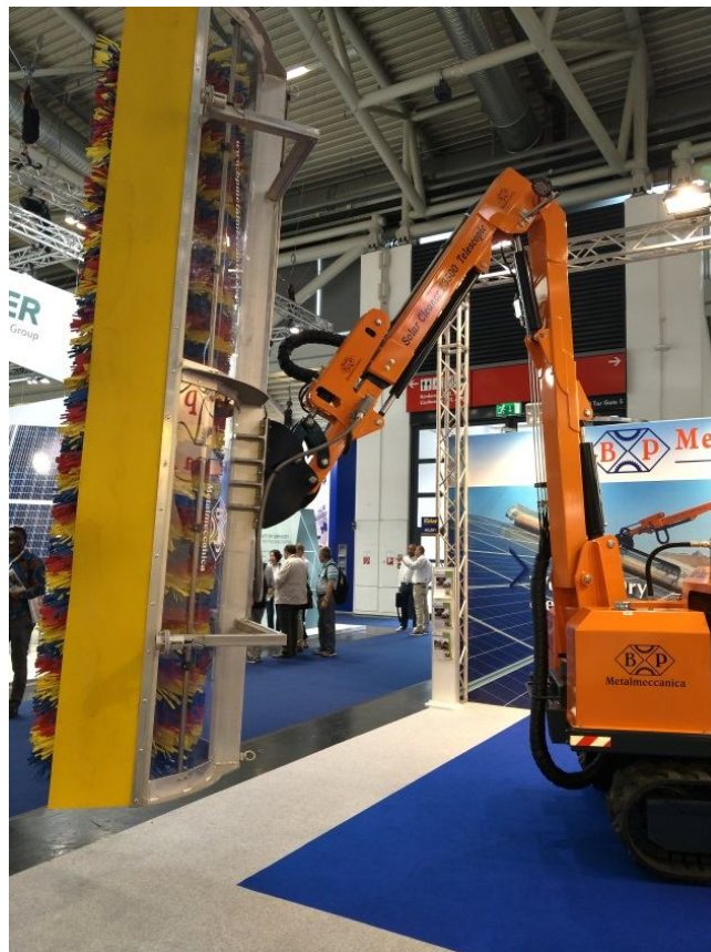
圖 21、大型太陽能板清洗裝置
