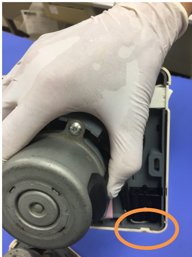
圖 22.換氣扇施加排水孔
