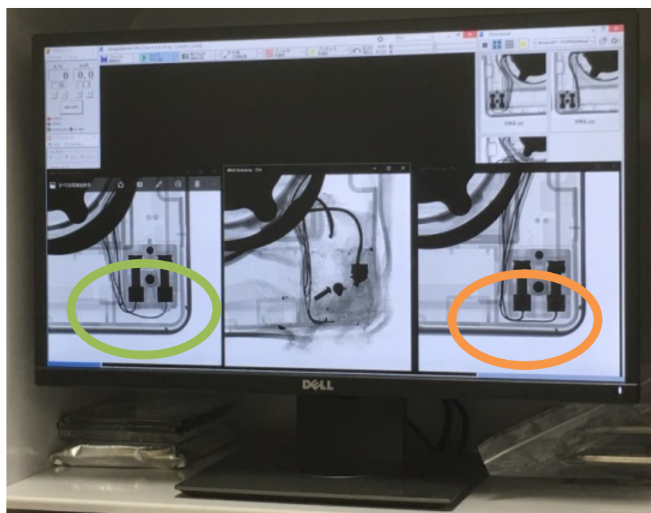
圖 20.換氣扇商品經 X 光顯像儀掃描結果
