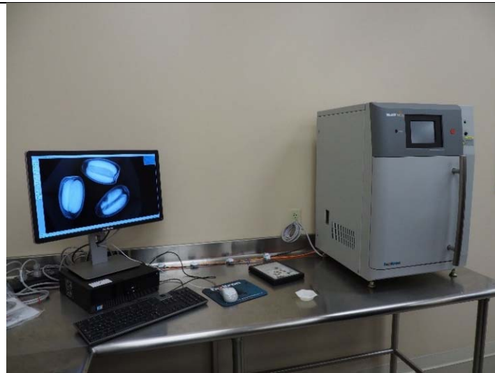
圖 15、Linden 植物檢疫站以 X 光儀協助檢測種子內食性昆蟲
