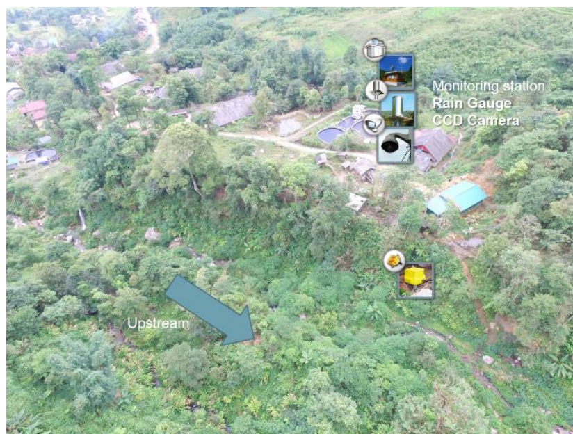
圖 16 土砂觀測站建站儀器配置建議(上游)
