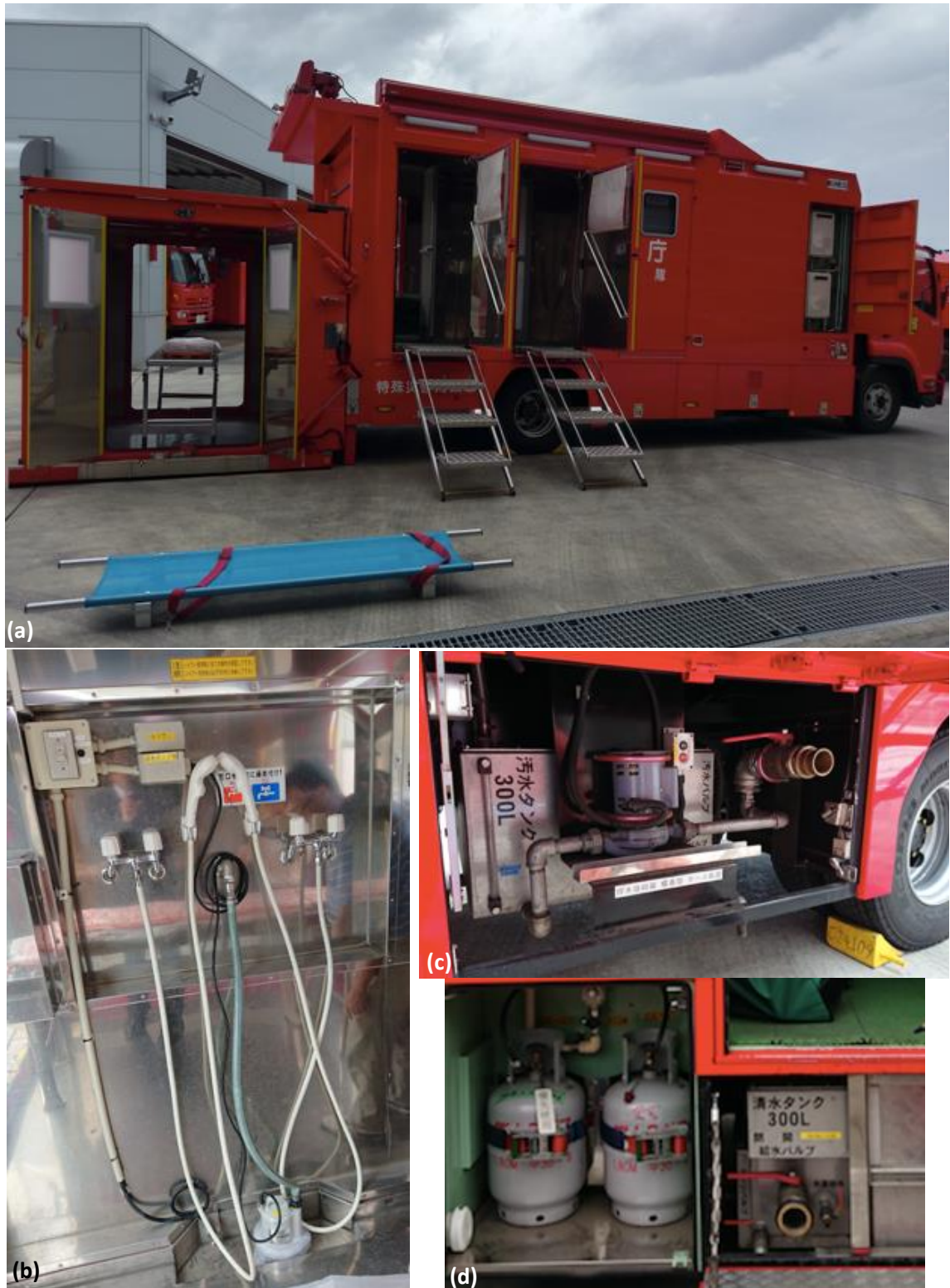
圖 34、圖(a)：第 9 消防機動部隊介紹其除污車，車上共有 3 間除污室，車體後方另有可以展開之擔架專用除污區，車上並配有熱水器；圖(b)：除污室內除污清洗設備；圖(c)：車底裝設之污染廢水的儲水槽；圖(d)：車體後下方裝設有乾淨水的儲水槽，以及提供熱水器加熱之瓦斯桶。
