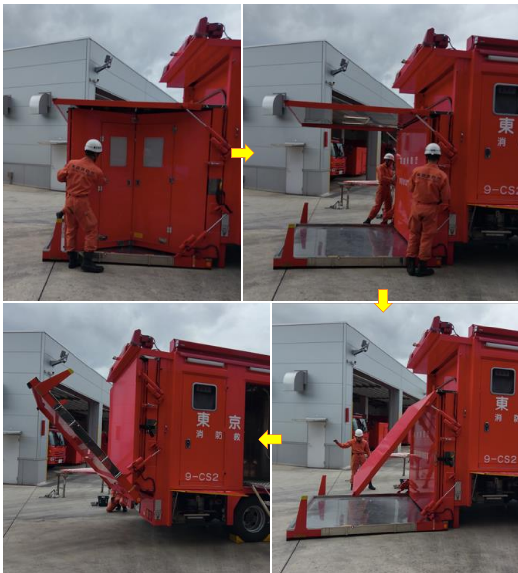
圖 35、第 9 消防機動部隊示範將除污車車體後方之擔架專用除污區收起。
