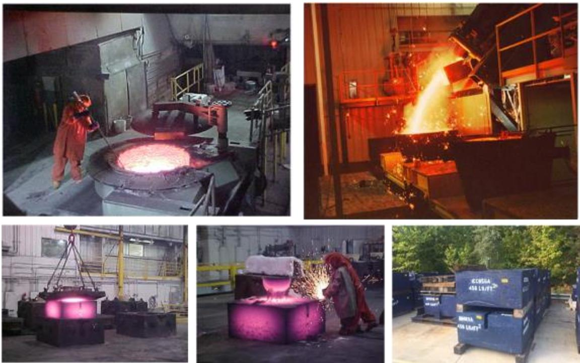
圖 3.5.2 回收金屬熔融及屏蔽金屬塊製成過程
