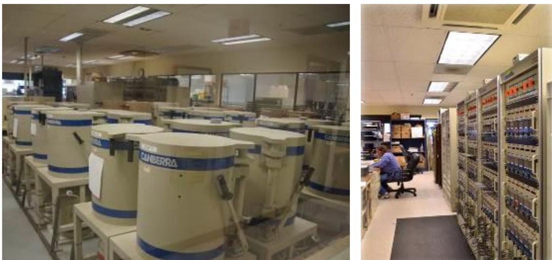
圖 3.3.5 Gamma spectrometers 及 Alpha spectrometers
