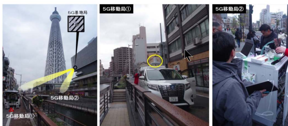
圖 1-1-4 5Gトライアルサイトにおける無線伝送試験
