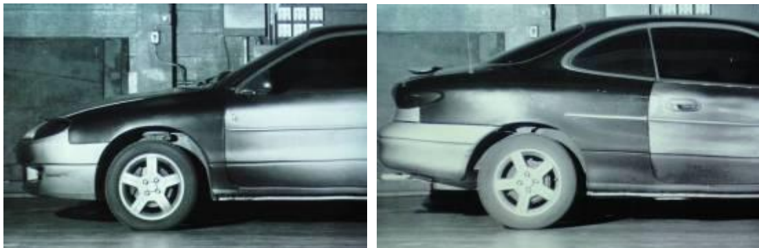
圖 18：車輛鋼板重新經過烤漆後，與原廠的烤漆不同，在紫外線攝影下亦能呈現顏色深淺的不同。
