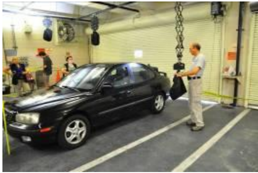
圖 3：車庫檢驗車輛用之燈光設備，該設備在天花板設有軌道，方便燈光移至不同位置及高度。
