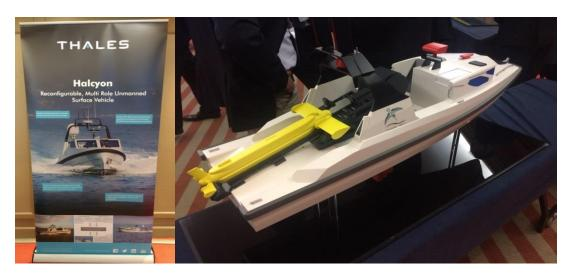
圖 1 翠鳥水面無人載具(HSUV)搭載 T-SAS 聲納系統模型
