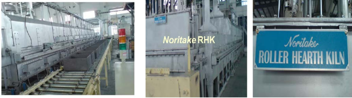
圖九、日本 Noritake 滾道式碳化爐
