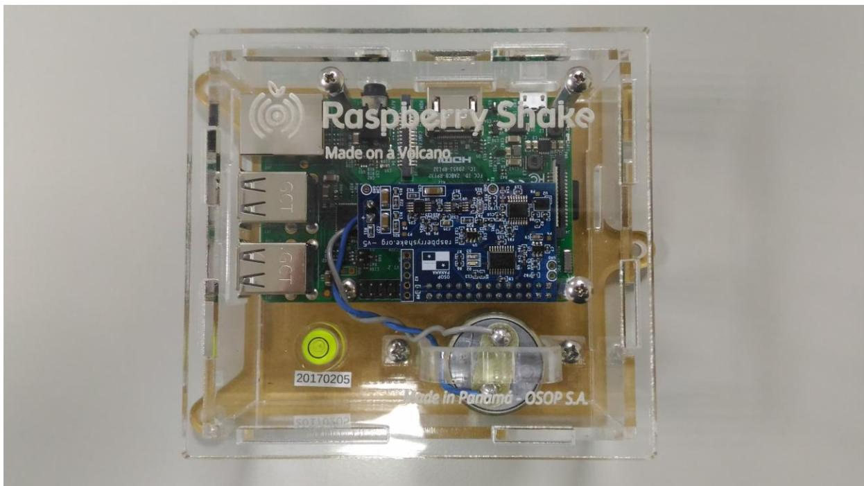
圖十一、Raspberry Shake，圖中顯示一個單軸的速度型地震儀，以及 Raspberry Pi 開發板。該開發板內建訊號濾波程式以及 SesicomP3 軟體，能夠透過網路將即時資料傳達遞給地震資料處理中心。
