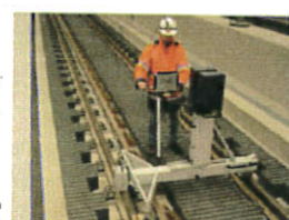
(c)德國 Spacetec 公司 T2 隧道影像攝影系統
