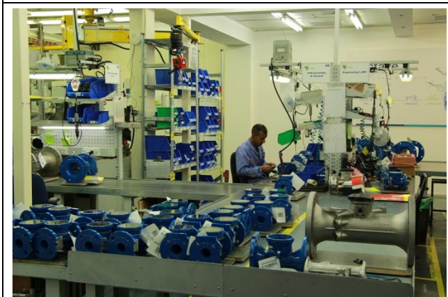
圖 3-43、水表生產線組裝作業
