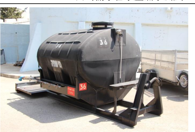
圖 3-8、移動式緊急供水設備(二)
