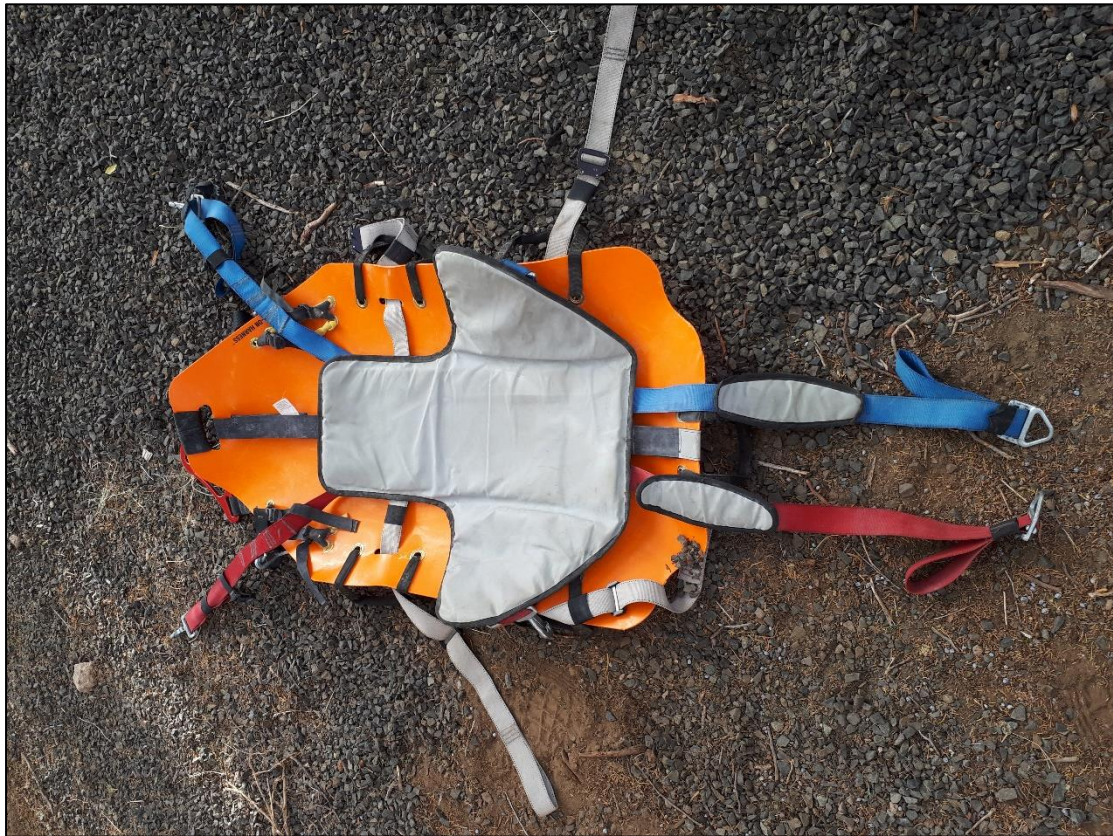
圖 1 半身式固定救援吊帶(CMC Rescue/SKEDCO Drag-N-Lift Harness™)
