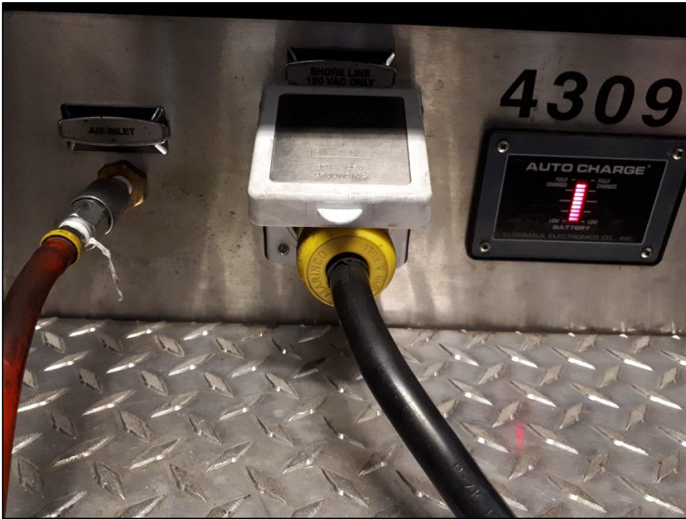
圖 33 消防車輛停妥後可直接電源與高壓空氣管
