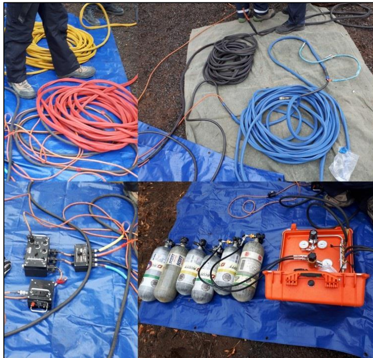
圖 27 氣源供應及通訊管線以顏色區分不同使用者
