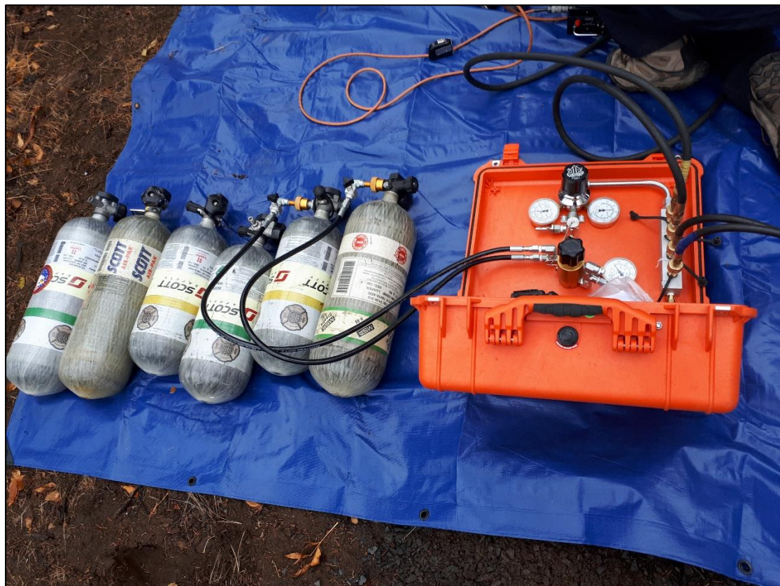
圖 10 輕量化手提供氣系統
