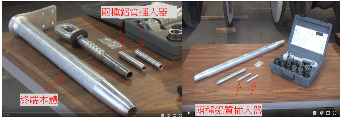
圖 22 壓接終端(Compression Deadend) 及壓接套管( Splice)
