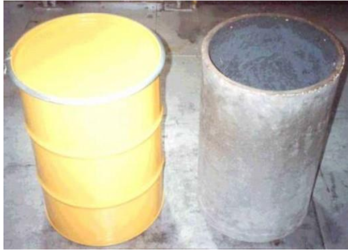
圖 3：利用除污後金屬製成之低放容器
