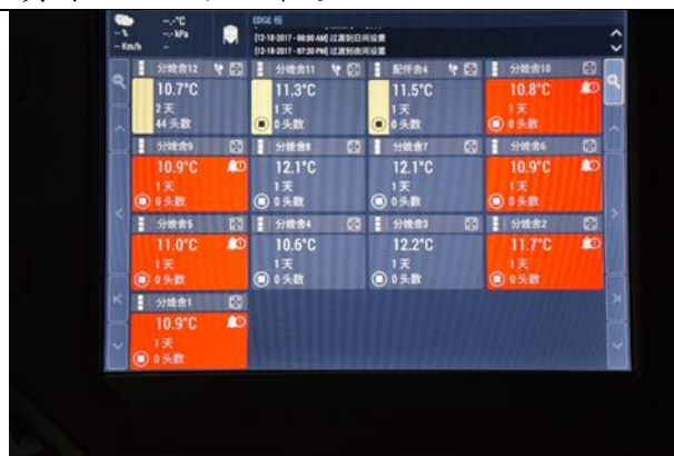
畜舍遠端自動化管理系統，全場有兩台控制主機，一台在員工辦公區，一台在分娩舍，可直接監控豬舍各單元的狀況(溫度、溼度等)，該系統可以連結智慧型手機或平板電腦。
