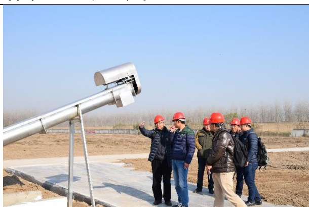
刮糞系統最末端的出設備，從畜舍內將糞便集中後輸送出來，由場內卡車運送至廢水處理場做下一步處理。
