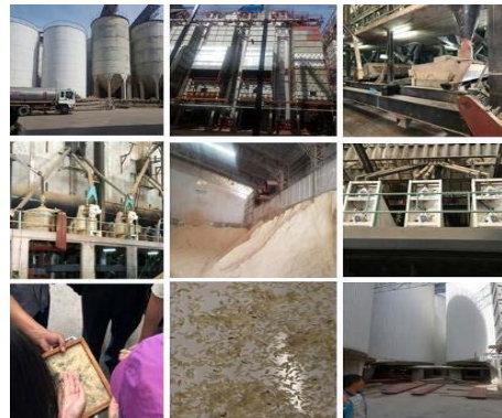
預熟米製程：稻穀浸泡（90°C 1 小時）→烘乾（13.5~14%）→礱碾→精白→選別→儲存
