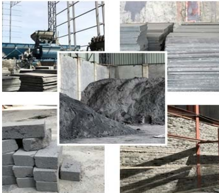
粗糠灰燼與水泥混合製成隔熱磚塊及隔板 建材
