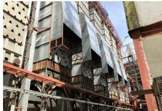
水晶米公司自製連續式乾燥機（1,000 公噸），其所需費用較購置三久產製者低
