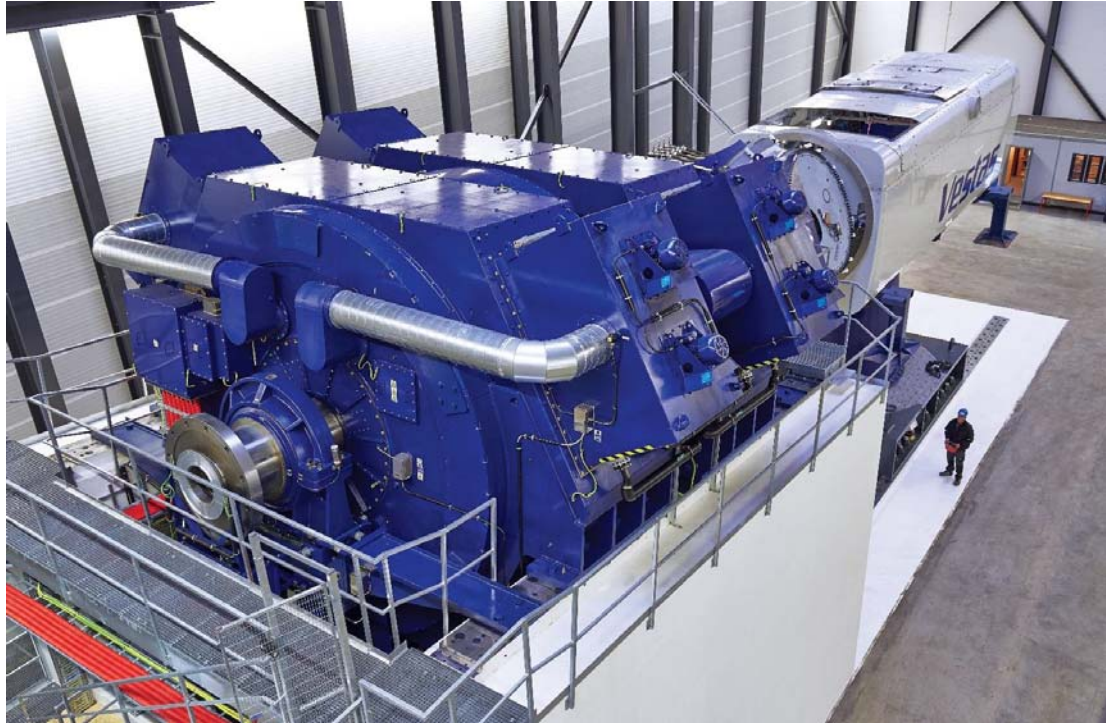
圖 18 LORC 機艙動力鏈測試 (資料來源：LORC)
