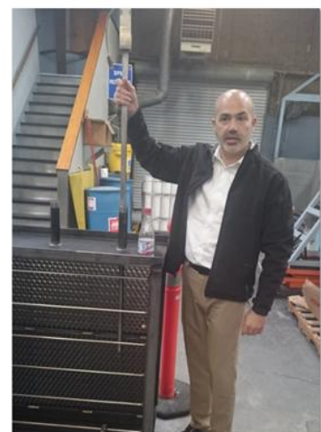
參訪AMC 的 VOLU-Probe/SS Array 結合整流板可準確測定風道風量
