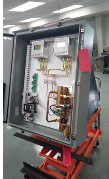
(上圖右) AMC 的 CAMS(Combustion Air Manage System)裝置
