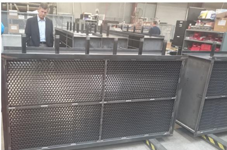
參訪AMC 的 VOLU-Probe/SS Array 結合整流板可準確測定風道風量
