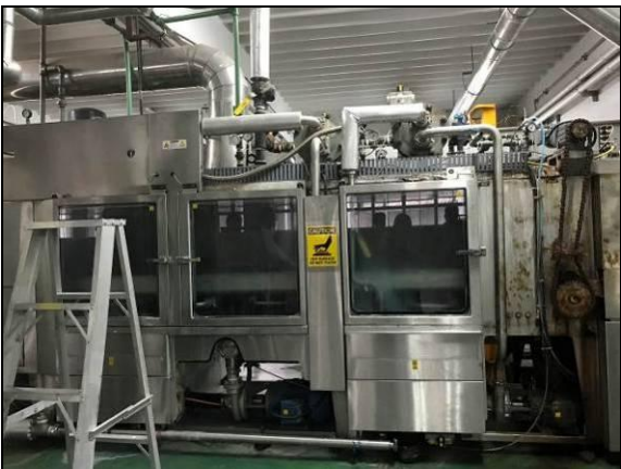
圖 19. 飼養器具以隧道式高溫清洗清洗後滅菌
