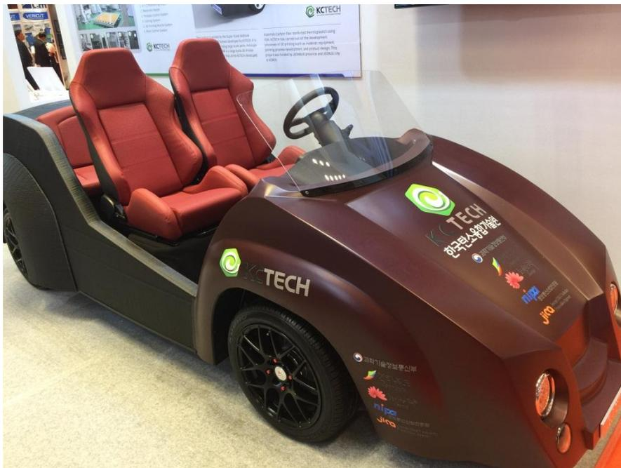
圖五、韓國 KC TECH 公司利用碳纖維複材使用 3D 列印方式生產的汽車
