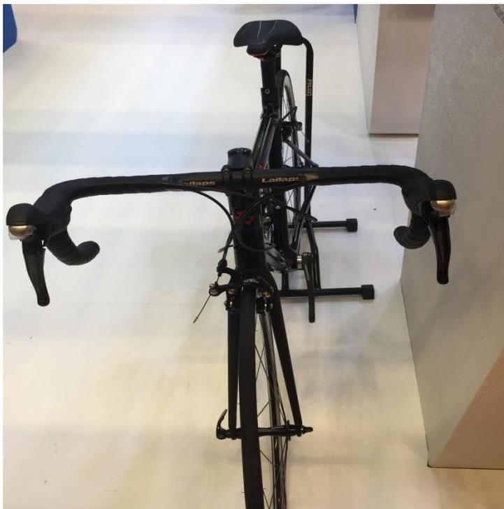
圖十一、使用機械自動編織的碳纖複材的腳踏車
