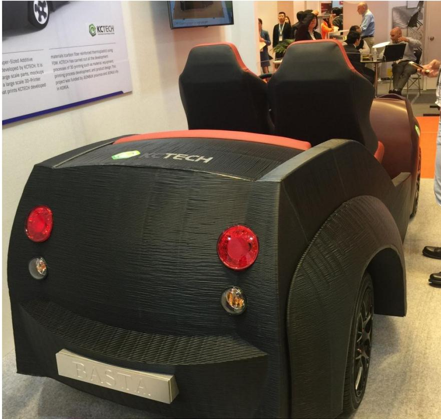
圖五、韓國 KC TECH 公司利用碳纖維複材使用 3D 列印方式生產的汽車
