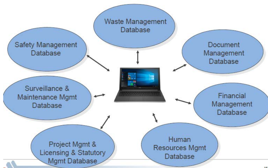
圖 5 除役期間紀錄管理系統(Record Management System, RMS)之類型
