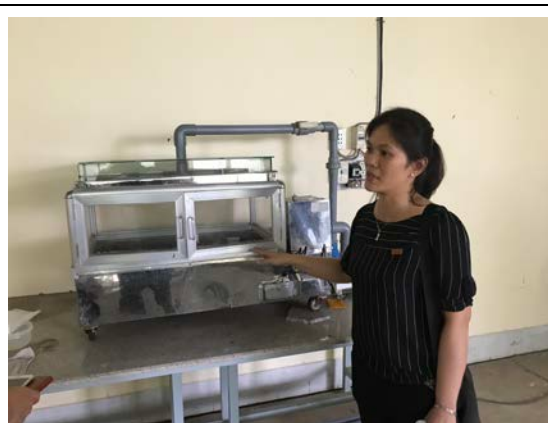
樹採後處理病害專家 Mrs. Ngoc (Nguyễn Khánh Ngoc) 導覽 SOFRI 內的採後處理設備以及果品評估流程，包括溫湯、冷卻、風乾、冷藏等。(圖為溫湯處理設備)
