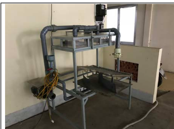
南方園藝研究院內的採後處理設備。(圖為冷卻處理設備)
