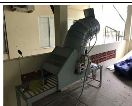
南方園藝研究院內的採後處理設備。(圖為風乾處理設備)
