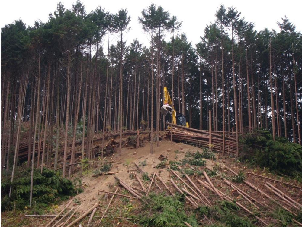
照片 20 伐木聚材機(Feller-buncher)作業
