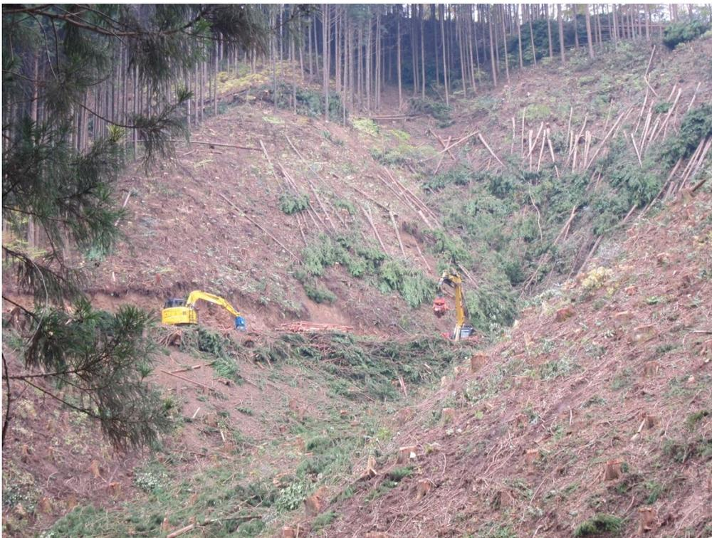
照片 21 造材加工機(Processor)與裝載機(Loader)並聯作業
