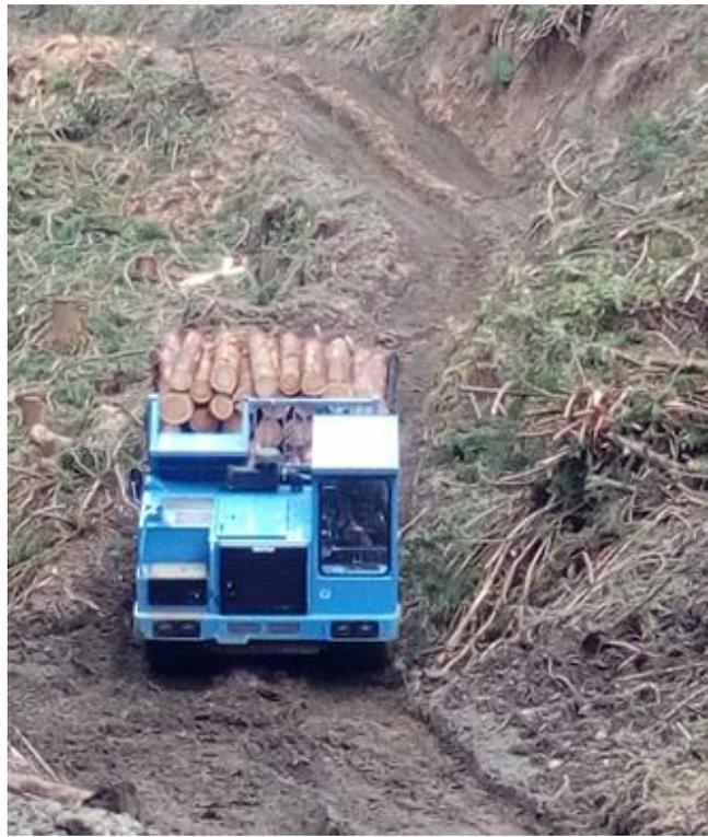
照片 23 集材功能履帶式林內運材車運材情形
