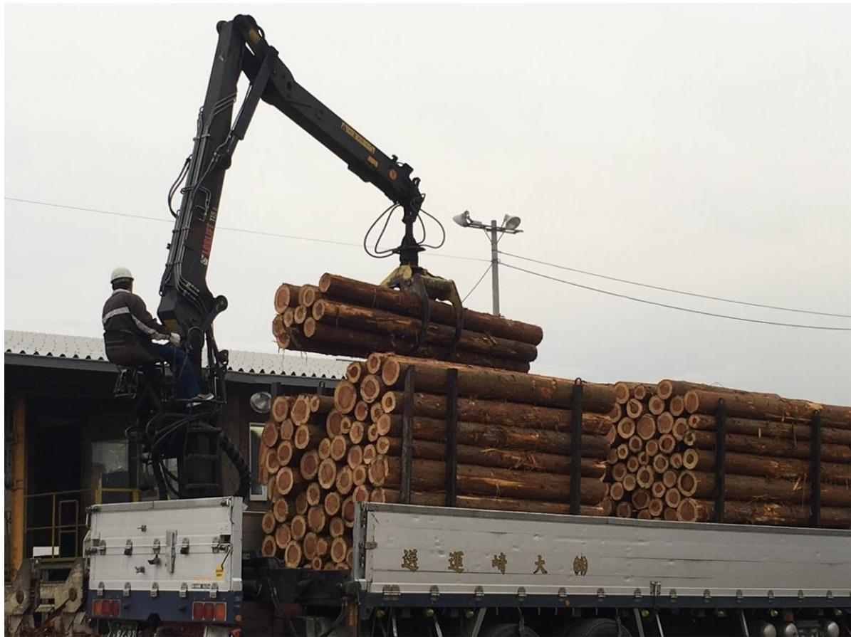
照片 30 利用伸縮臂抓溝進行高效率原木之卸整作業
