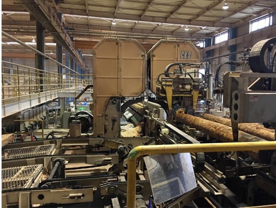
照片 31 自動化雙帶鋸製材作業
