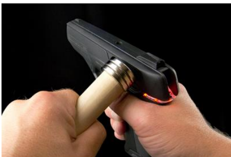
圖 16：Smart Gun 繞過驗證攻擊流程
