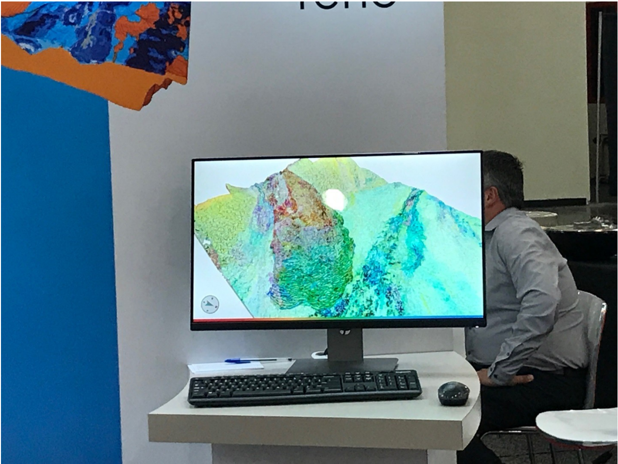
圖 26、GeoTeric 軟體利用頻譜分解展示在震測資料中的古冲積扇與水道。
