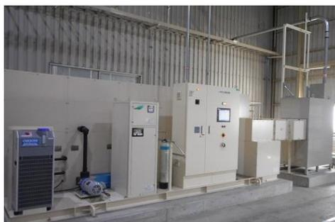
圖 15. 日立造船固態高分子型水電解製氫裝置「Hydro Spring」
