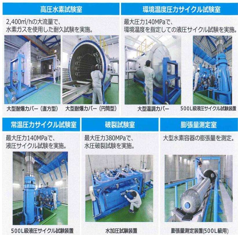
圖 9. 氫能製品研究試験中心研究室
