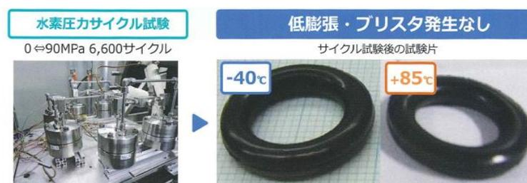
圖 13. 高壓氫氣密封用橡膠(高压水素シール用ゴム)
