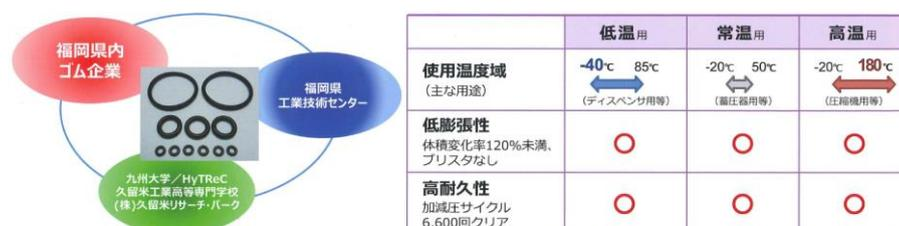
圖 11. 福岡縣工業技術中心研發耐高壓氫氣專用 O 型環
