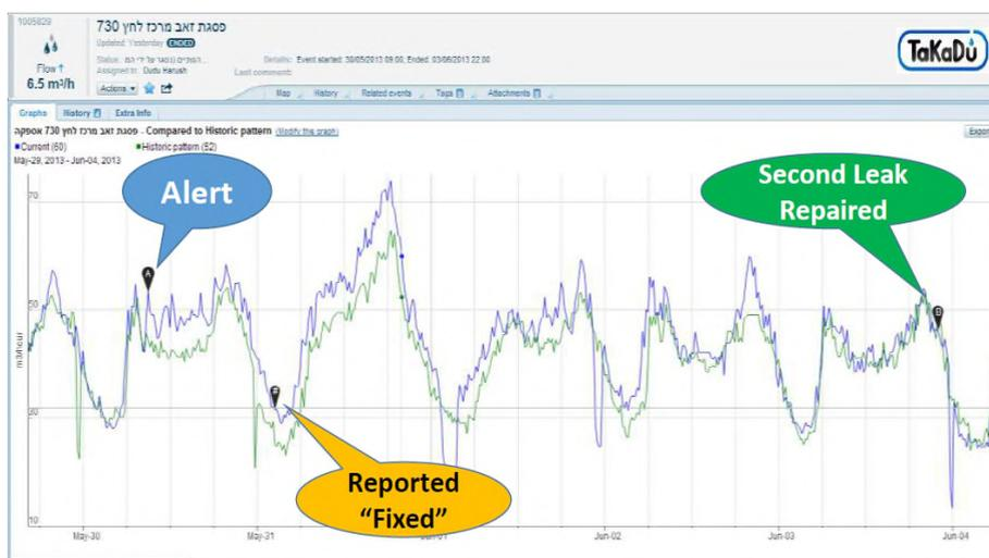
圖 2：TAKADU 『智慧水網雲端管理系統』事件警示及修復圖
