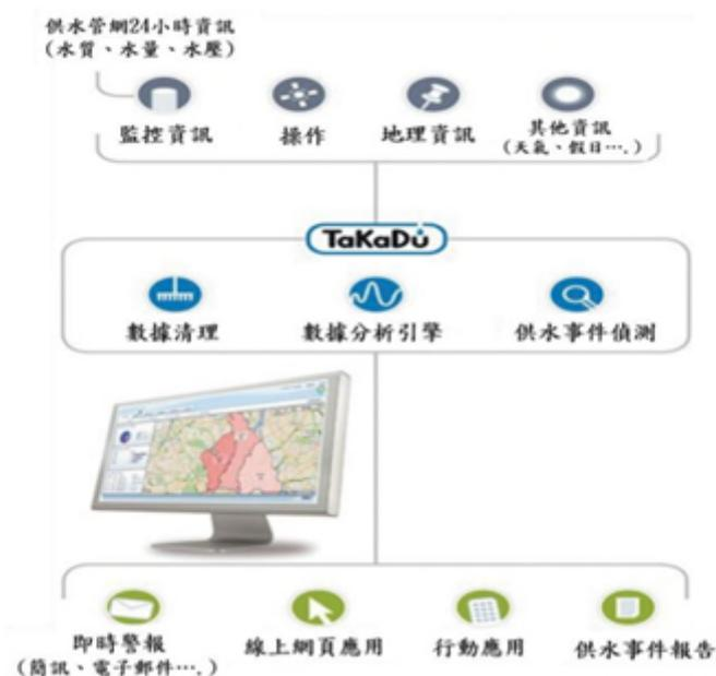
圖 10：Takadu 『智慧水網雲端管理系統』
