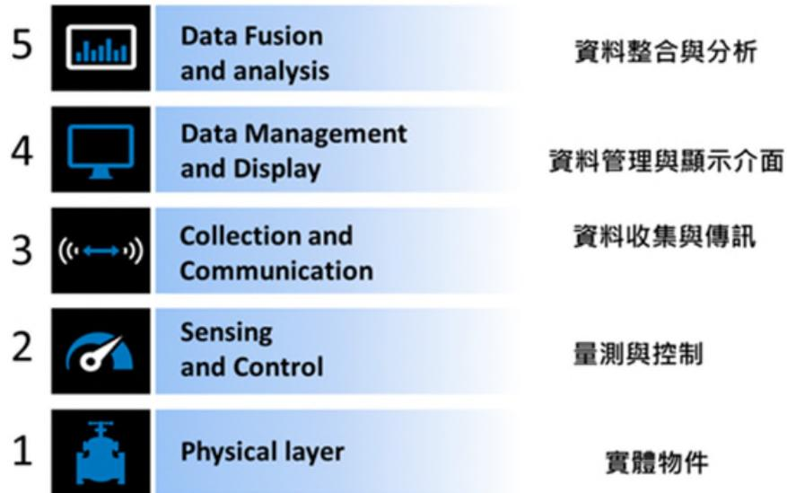
圖 11：智慧水網階層示意圖
